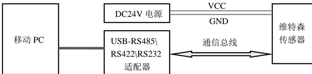
图 7 传感器配置电气连接图
