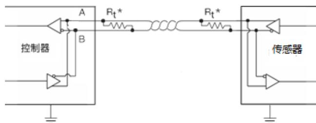
图 3 RS485 电气连接图
